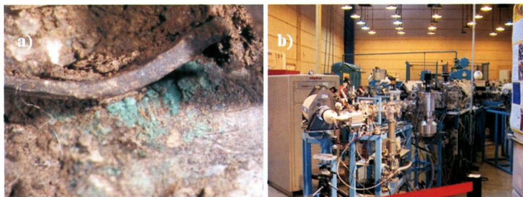
Figura 6 a) Fotografía de la soldadura entre los lazos con el anillo, nótese los cristales del óxido de cobre en la intersección con el anillo; b) "Peletrón", mediante el cual se realizan los análisis PIXE.
